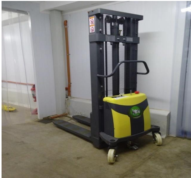
Figura 1.33. Apilador eléctrico de 1500 kg y mulitas de arrastre.
