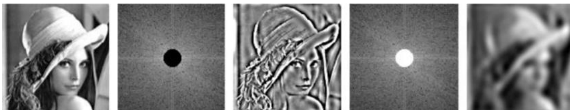
Ejemplo de un filtrado de bajas frecuencias
