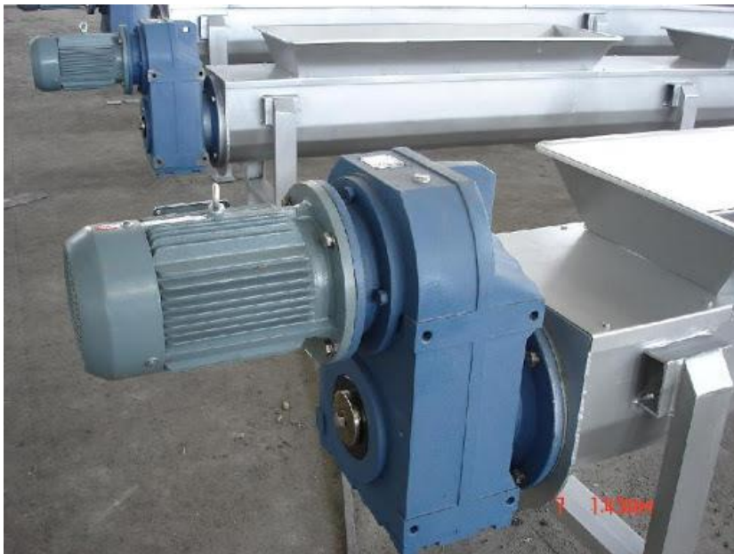
Ilustración 35 - Motor con reductor montado en un tornillo sin fin. Fuente: http://www.gearboxtransmission.com/ , 2020.
