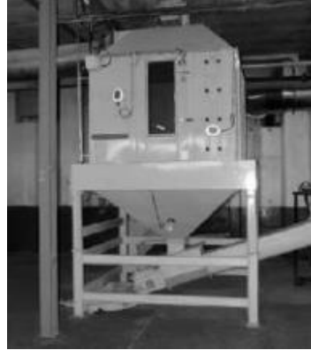
Ilustración 62 Máquina enfriadora a contraflujo. Fuente: BORTONE, 2020.
