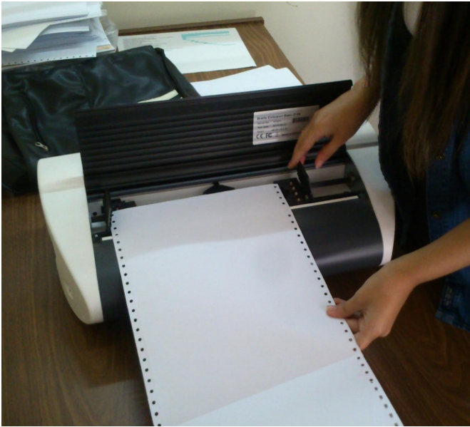
Fig.4. 3: Hardware - Colocación del papel en el sistema continuo
