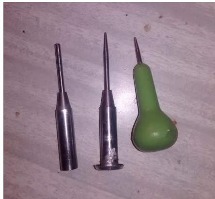
Fig.5. 13: Modificación del pin del embolo EKS
