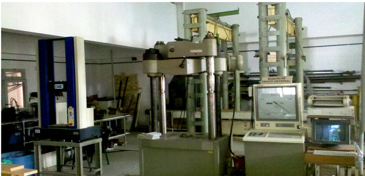
*Máquina de Ensayo Universal - Laboratorio Civil - FRCU*
