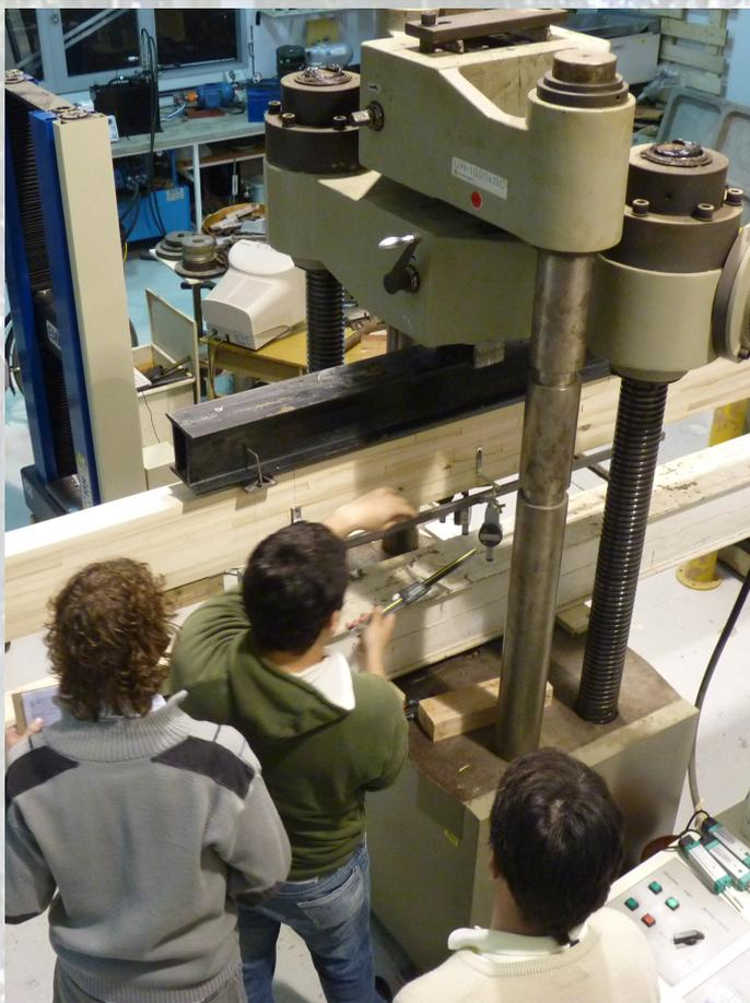
Máquina de Ensayo Universal - Laboratorio de Civil
