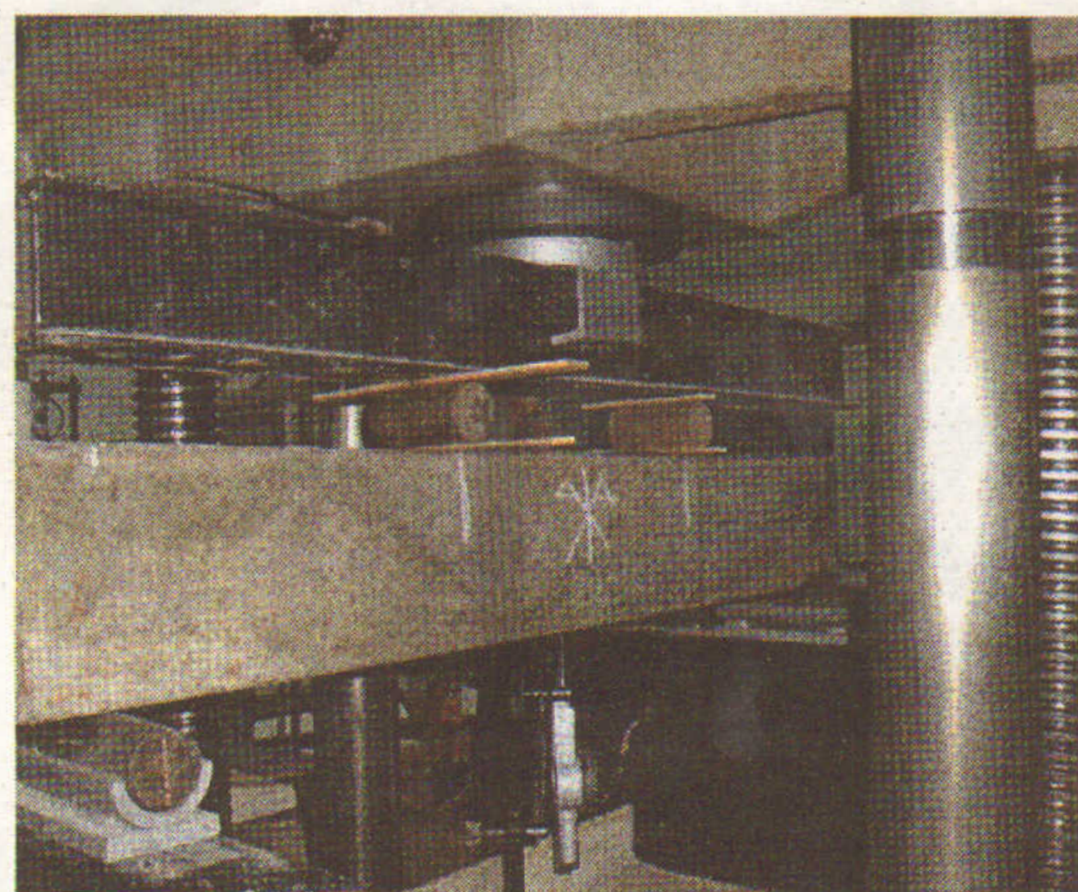
Ensayo viga de hormigón
