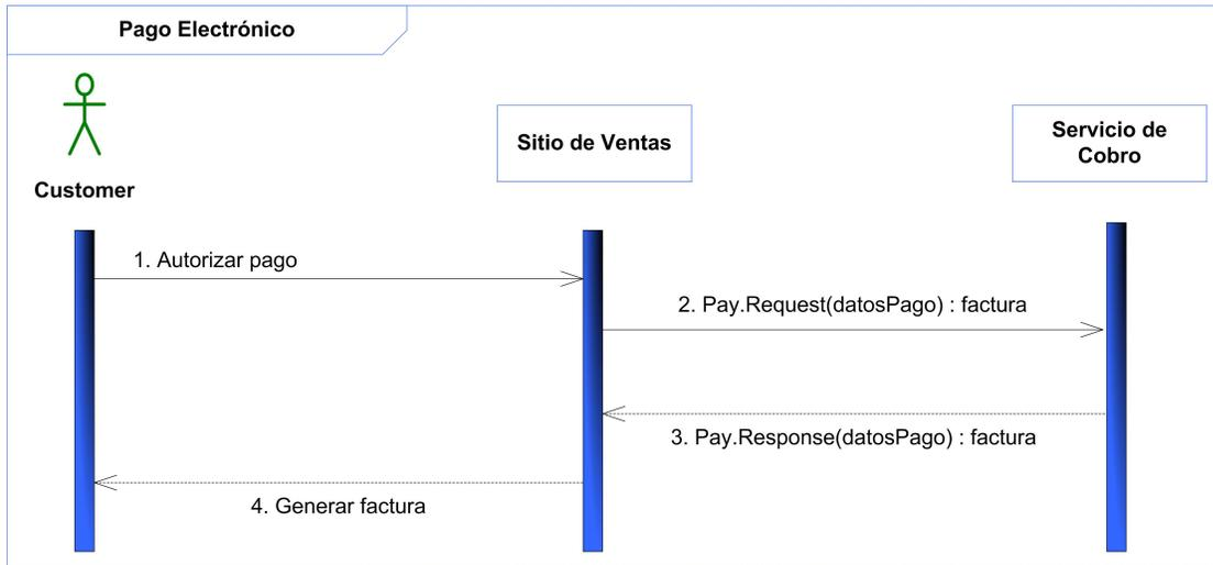
Figura 5.17: Diagrama de secuencia de integración con servicio de cobro
