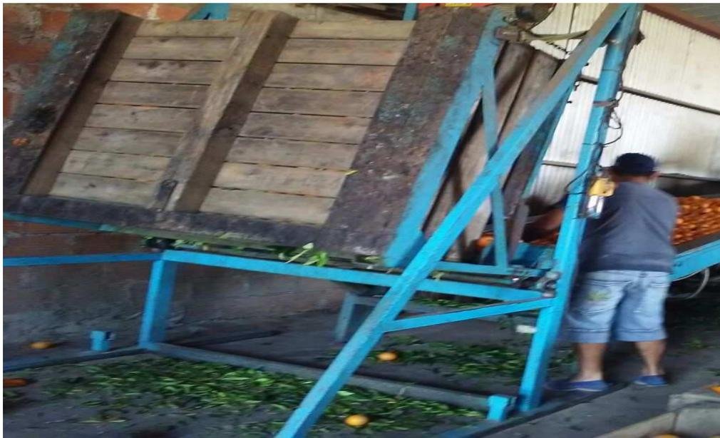
La fruta es volcada a unos “transfer” (cinta transportadora con rodillos) que dirigen la fruta a la cepilladora donde los cítricos son mojados con agua mediante un sistema de mangueras y picos colocados por encima de ellos, para ser limpiados.
