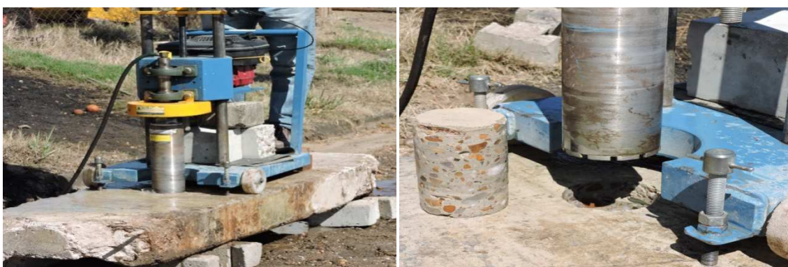
Figuras N°8 y N°9: Vista equipo extractor de testigos, sobre ménsula colapsada. Vista del testigo extraído.
