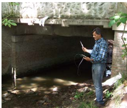
Fig. 1 – Mediciones de CO 2 realizadas en cercanías de un puente.
