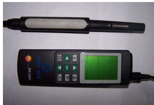
Fig. 2 - Detalle del equipo TESTO modelo 445 con sonda infrarroja.
