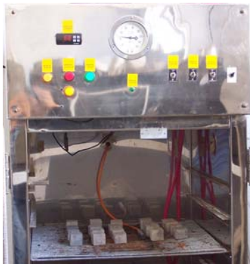
Fig. 3 - Detalle de la cámara de carbonatación acelerada. Se observan los especímenes en su interior.
