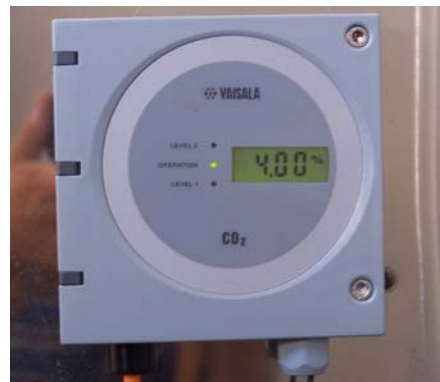
Fig. 4 - Detalle del lector de CO 2 VAISALA GTM 221. Se observa el nivel de concentración de CO 2 en el interior de la cámara.
