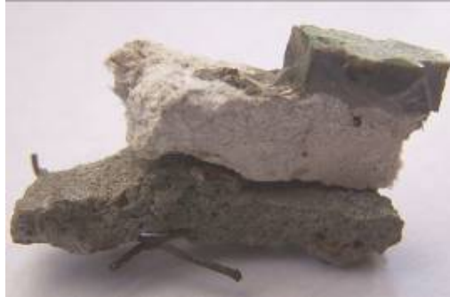
Fig. 18: Detalle del material de la escultura. Se observan las tres capas de morteros.
