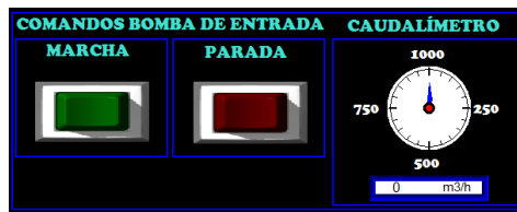
Fig. 27 Comandos Bomba de entrada y Caudalímetro - Planta de Osmosis
