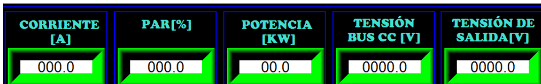
Fig. 24 Indicadores de Parámetros Eléctricos
