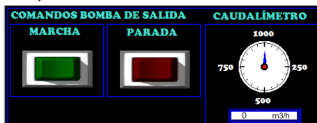
Fig. 28 Comandos Bomba de salida y Caudalímetro - Planta de Osmosis
