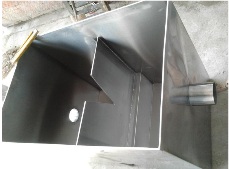
Fig. 142 –Cámara de Registro de Agua Potable – Fuente: Elaboración Propia.
