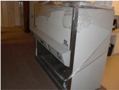
En esta cabina de seguridad biológica el aire es arrastrado desde el interior del laboratorio o desde el exterior. Todos los flujos de entrada de aire se agota a través de un filtro sin recirculación.
