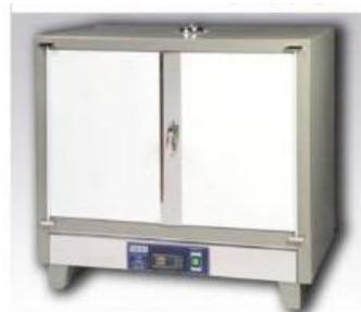
Cuenta con gabinete de acero esmaltado, interior de acero inoxidable y doble puerta. Posee control de temperatura digital programable de 50°C a 200°C +/-0.1°C, con doble visor y con display digital.
