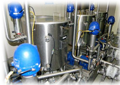
Fotografía 4.5.4.6. Filtrado y homogenizado de huevo líquido o albúmina.
