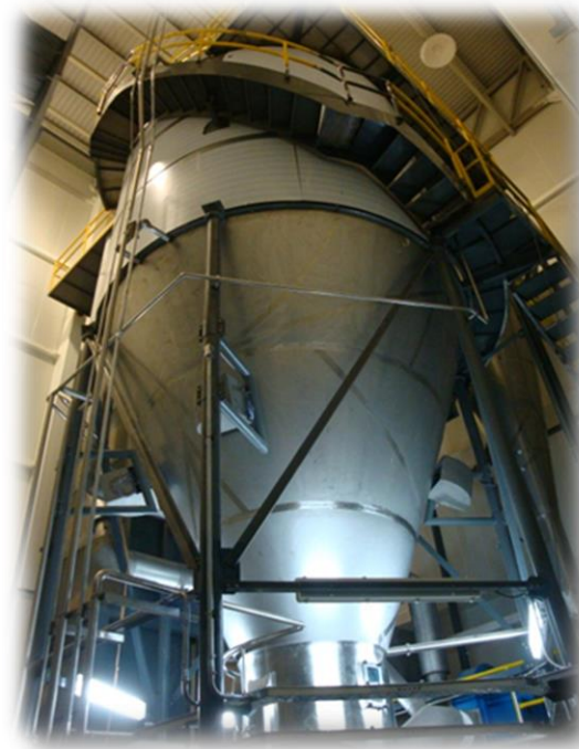
Fotografía 4.2.4. Equipo para el secado de ovoproducto.
