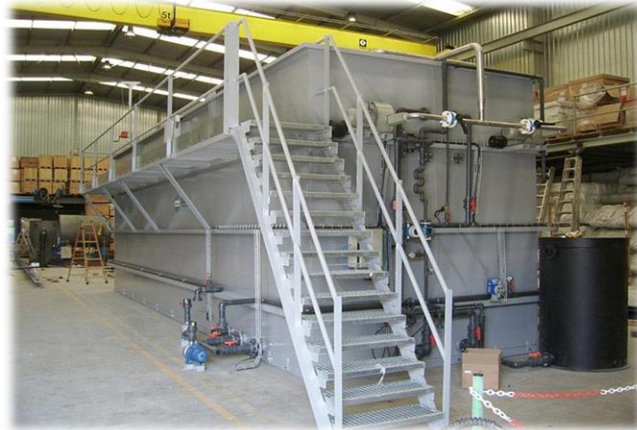
Ilustración 4.1.3.1 Planta de tratamiento compacta para industria ovoproducto.
