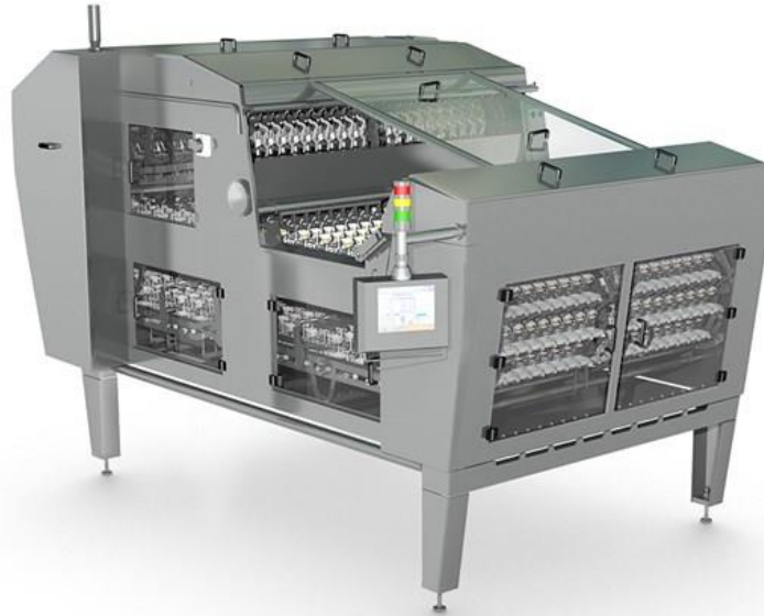
Imagen 4.2.5.3 Equipo de quebrado y separación de huevos.
