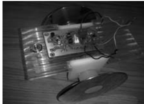
Fig.3: Estructura del robot con microprocesador MSP430G2553
