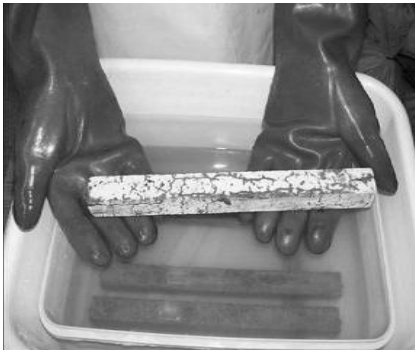
Figura 4: Fisuración en la barra de mortero
