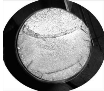
Figura 1. Ruptura por fatiga
