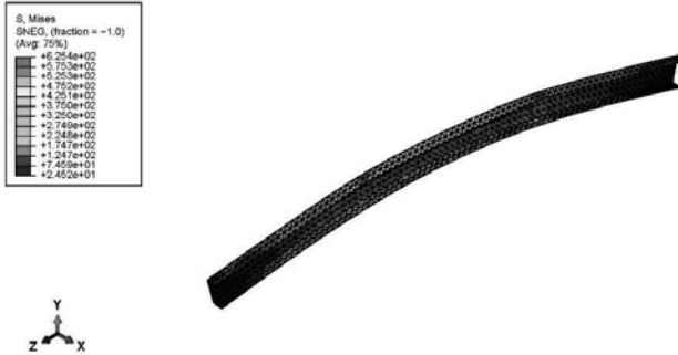
Fig 5. Detalle de los esfuerzos en el travesaño más solicitado (Valores en Kg/cm 2 ).
