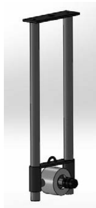
Figura 5. Guías y soporte de mandril móvil
