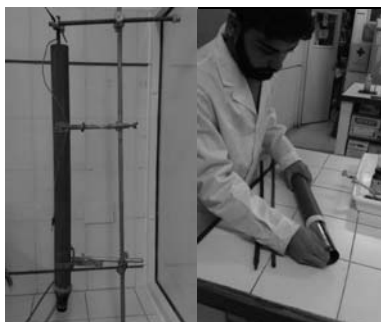
Fig. 2- Esquema del floculador izq. Primer prototipo montado centro Detalle de inserción de electrodo de cobre der.
