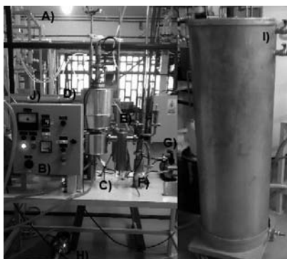
Figura 2. Equipo de destilación molecular: A) Alimentador. B) Tablero. C) Condensador. D) Cuerpo del destilador. E) Trampa de frío. F) Bomba difusora. G) Bomba de vacío. H) Bomba de agua. I) Tanque de agua. J) Sistema de calefacción con aceite térmico.
