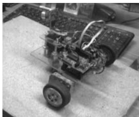
Fig.6: Versión anterior del robot con ruedas más anchas y mayor peso.
