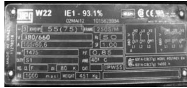
Figura 1. (a) Montaje para las mediciones. (b) Datos nominales del variador de frecuencia medido. (c) Datos nominales del motor accionado por el variador de frecuencia.
