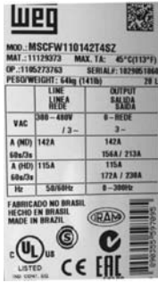
Figura 1. (a) Montaje para las mediciones. (b) Datos nominales del variador de frecuencia medido. (c) Datos nominales del motor accionado por el variador de frecuencia.
