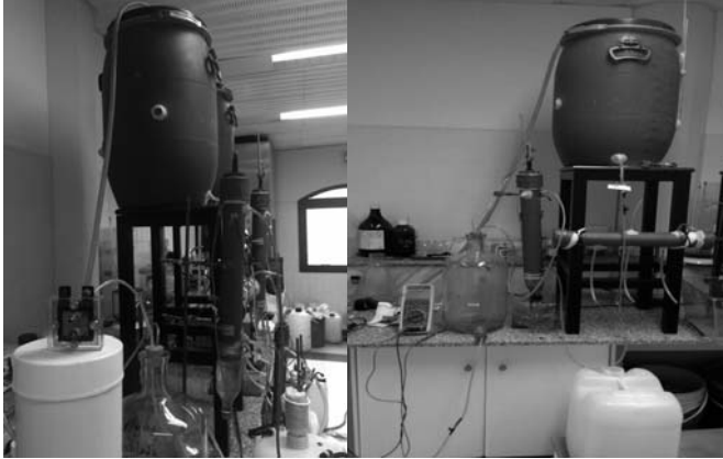
Fig. 3-Vista del electrocoagulador y el sistema colector de hidrógeno en funcionamiento, con pila de hidrógeno
