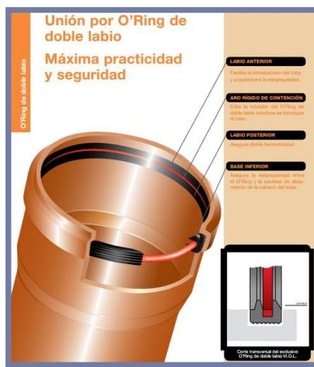
Figura 10.63 Unión O'Ring Doble Labio.
