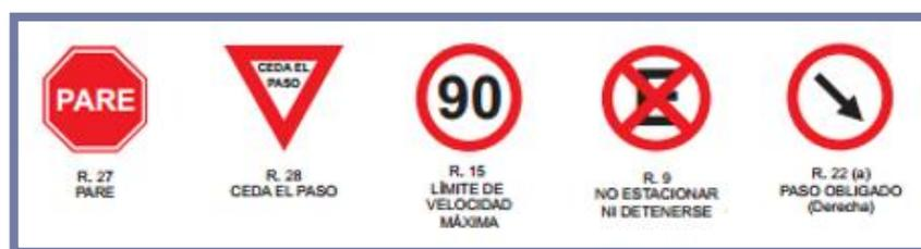
Figura 8.22 Señales de Reglamentación.
