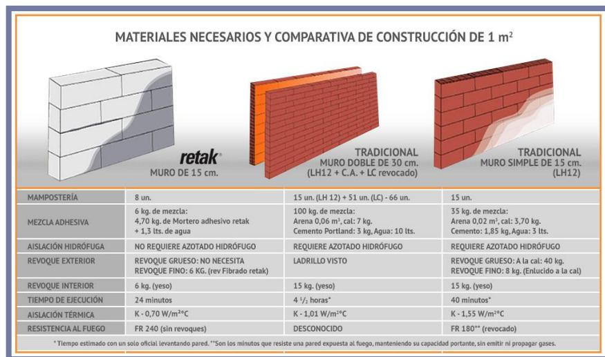
Figura 10.2 Comparación frente a Muros de Mampostería.
