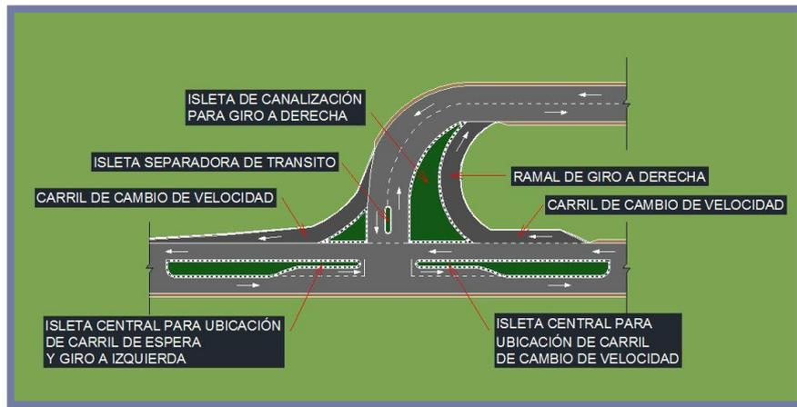
Figura 8.8 Esquema de Intersección Propuesta.
