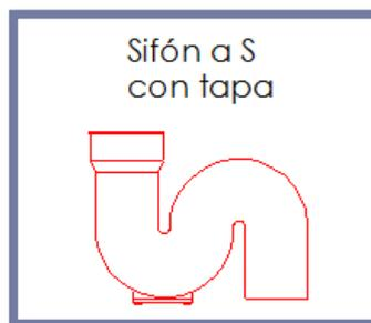
Figura 10.41 Sifón con Tapa de Inspección.
