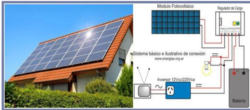
Figura 9.1 Paneles Solares Fotovoltaicos.
