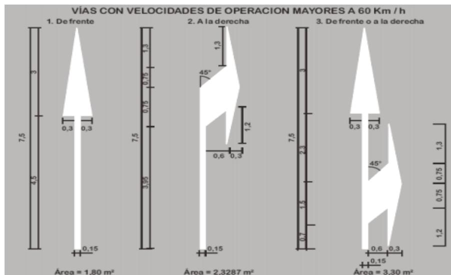
Figura 8.31 Dimensiones de Marcas sobre el Pavimento en Forma de Flechas.
