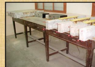
Grupo de probetas en proceso de corrosión acelerada.
