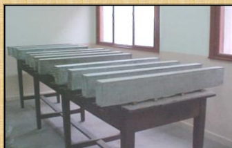
Vista de las probetas de hormigón armado, usadas en los ensayos de corrosión acelerada.
