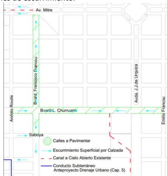
Figura 6-7 | Escurrimiento Pluvial de Calles a Pavimentar.
