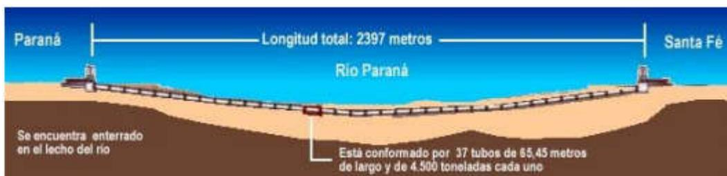
Figura 2-7 | Perfil longitudinal del Túnel
