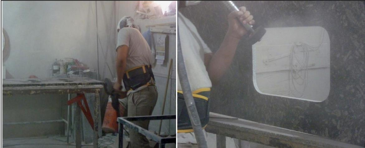
**Pulido con amoladora y disco abrasivo; y con maquina de eje flexible**
