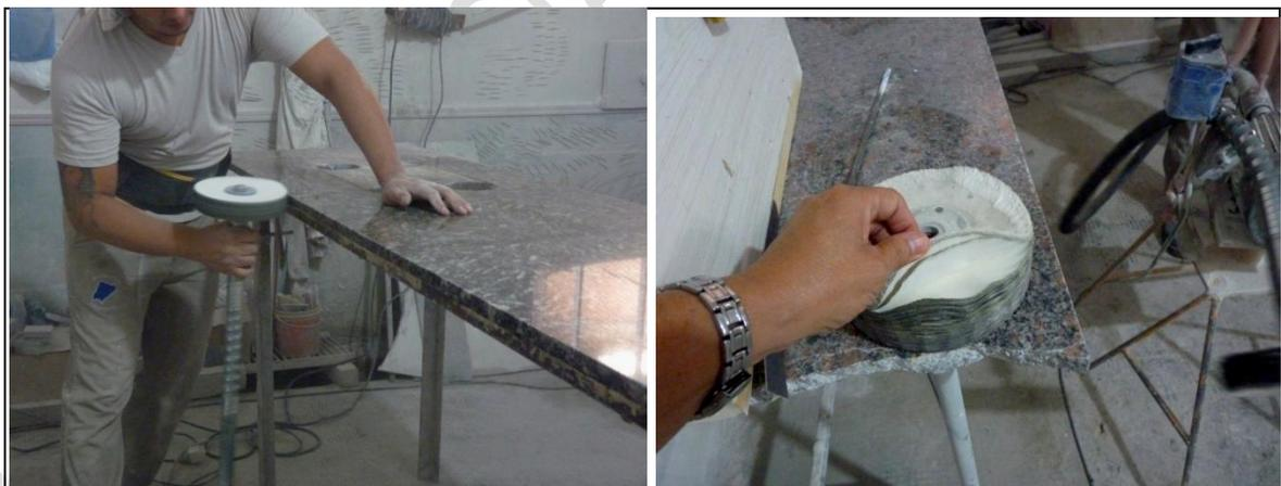
**Pulido con maquina de eje flexible y disco de tela**
