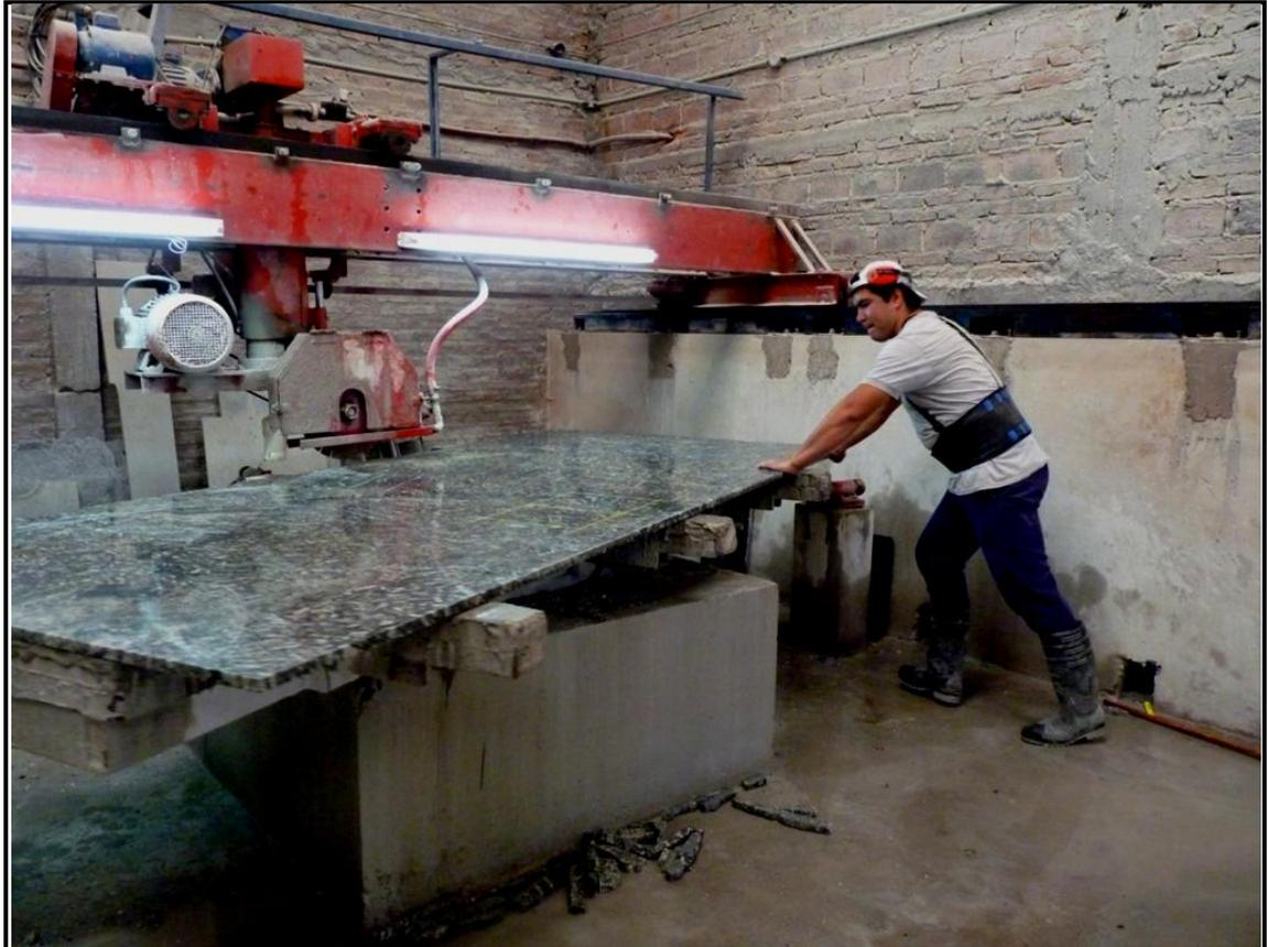
Luego de recortada la placa se marca las dimensiones de la mesada según las indicaciones en la orden de trabajo con escuadra, cinta métrica y un lápiz especial color amarillo y en caso de llevar una bacha, se marca para su posterior corte.
