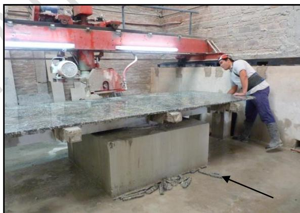
20-Las partes móviles de discos de corte tienen protección, solo la amoladora portátil no tiene protección, y se ha invertido el giro del motor para que en caso de resbalarse no salga hacia el cuerpo del operario. A la polea del motor de la perforadora se le quito la protección para reparar y nunca se colocó.
