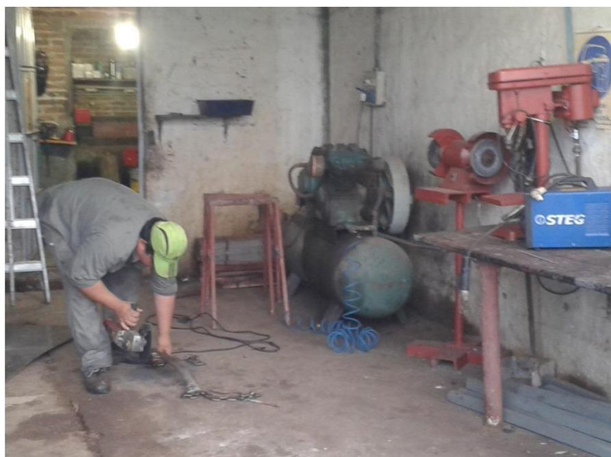
El riesgo es la explosión de cilindro si falla la válvula de escape o el presostato (sensor de corte de energía por exceso de presión).
