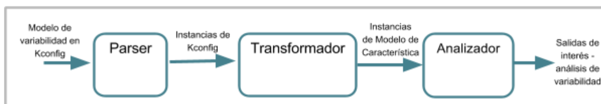
Figura 5.1. Arquitectura propuesta para la lógica de la herramienta.
