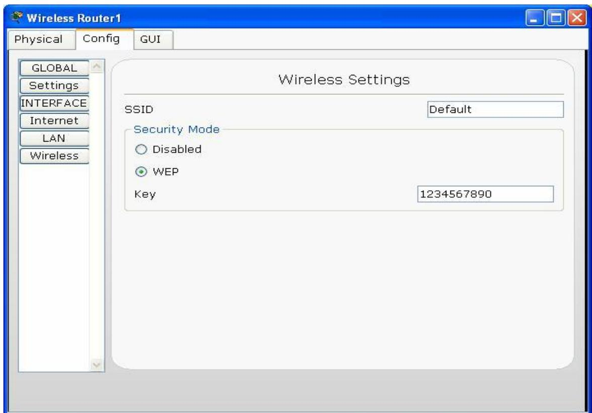
Obsérvese, que si activamos el protocolo WEP en el router, los equipos o host no establecerán comunicación con él hasta que en cada uno de ellos no se defina que se utilizará éste protocolo y se defina la misma contraseña de encriptación configurada en el router. En la siguiente figura se ilustra claramente ésta situación. En la primer figura se evidencia que ninguno de los host inalámbricos presenta comunicación con el Router, y
