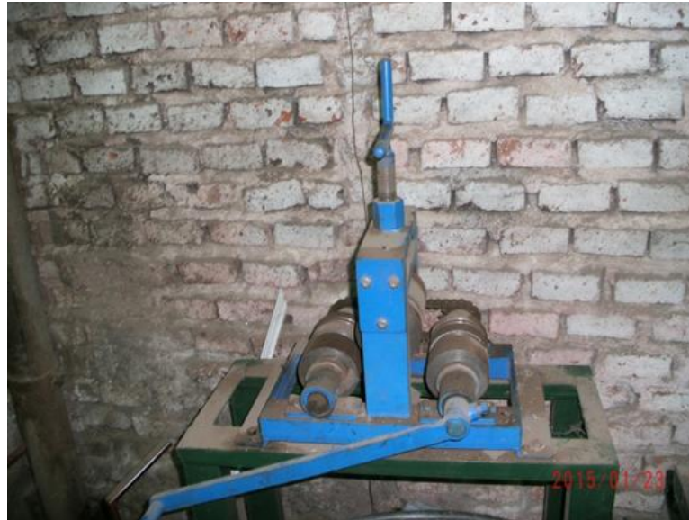
Imagen N°44: Dobladora de caños Fuente: Elaboración propia – Fotografía tomada in situ
