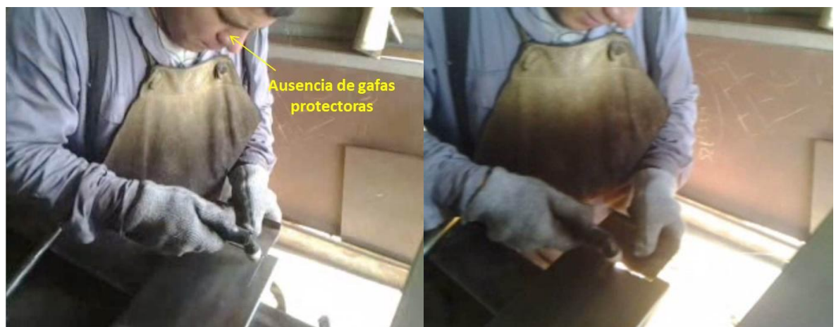
Imagen N°92: Uso de cortadora de plasma Fuente: Elaboración propia – Fotografía tomada in situ
