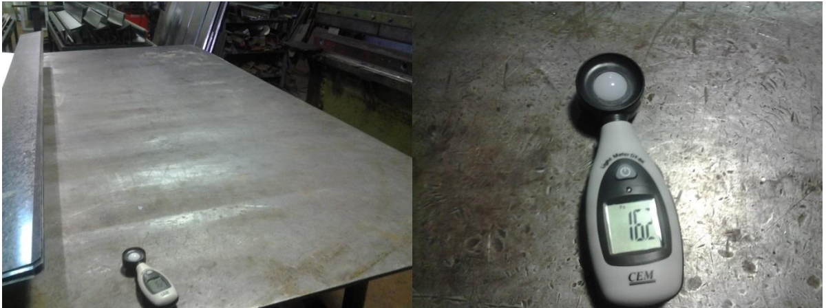
Imagen N°73: Luxómetro sobre mesa de trabajo de la plegadora Fuente: Elaboración propia
