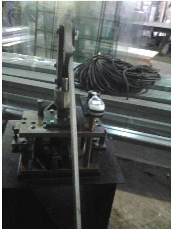
Imagen N°66: Luxómetro ubicado sobre plano de punzonadora Fuente: Elaboración propia
