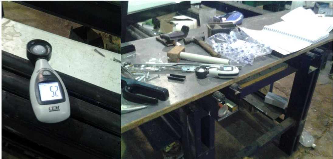
Imagen N°64: Luxómetro ubicado en mesa de trabajo Fuente: Elaboración propia
