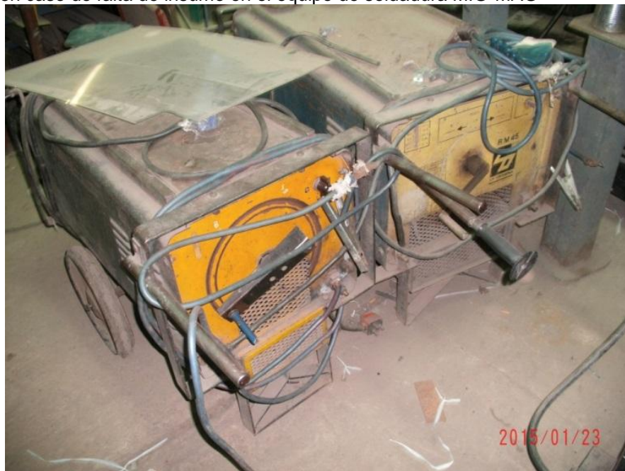
Imagen N°29: Soldadora Eléctrica Fuente: Elaboración propia – Fotografía tomada in situ
