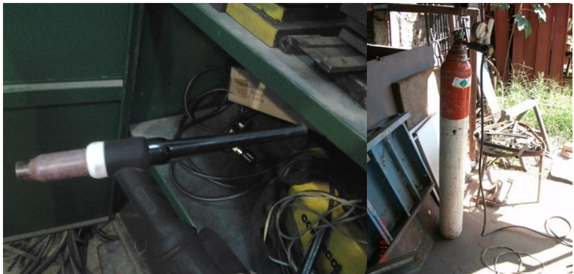
Imagen N°45: Antorcha con electrodo de tungsteno – Tubo de Argón Fuente: Elaboración propia – Fotografía tomada in situ
