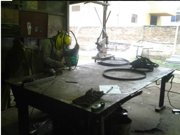
Imagen N°77: Luxómetro sobre la mesa de trabajo del soldador Fuente: Elaboración propia
