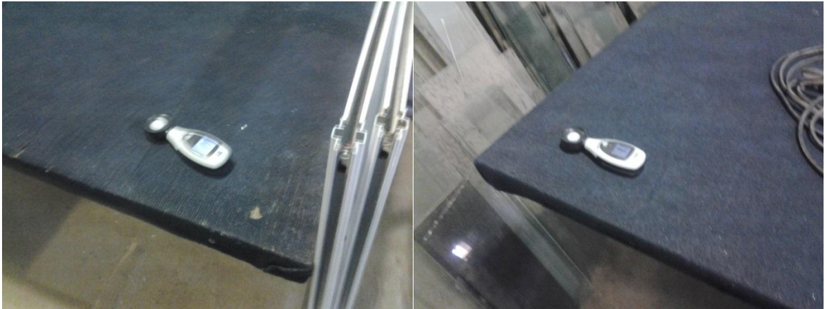
Imagen N°69: Luxómetro sobre mesa de corte de vidrio Fuente: Elaboración propia
