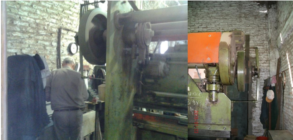
Imagen N°26: Plegadora – Mecanismo Fuente: Elaboración propia – Fotografía tomada in situ
