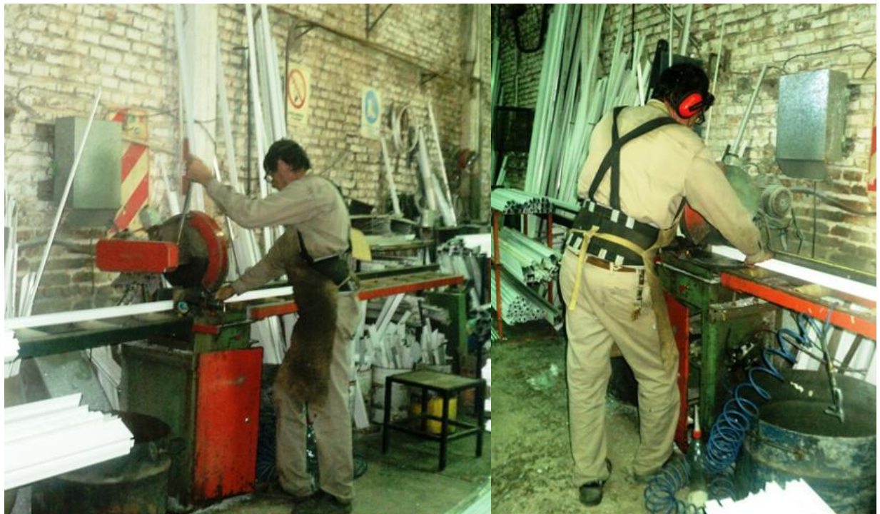
Imagen N°35: Corte con Sierra Sensitiva Fuente: Elaboración propia – Fotografía tomada in situ
