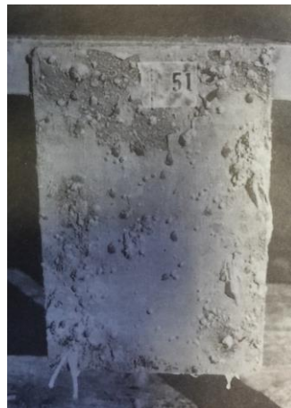
Figura IV.19. Panel corroído, pintura antiincrustante de reducida eficiencia, 33 meses de inmersión
