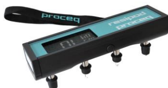
Figura V.15. Dispositivo comercial portátil para la medición de resistividad con sondas Wenner
