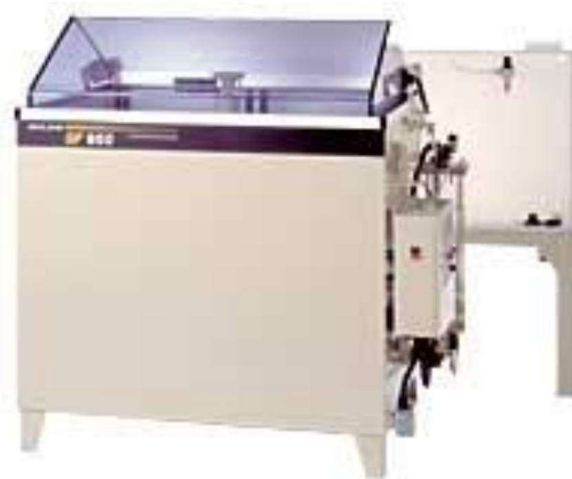
Figura I.4. Cámara de Niebla Salina
