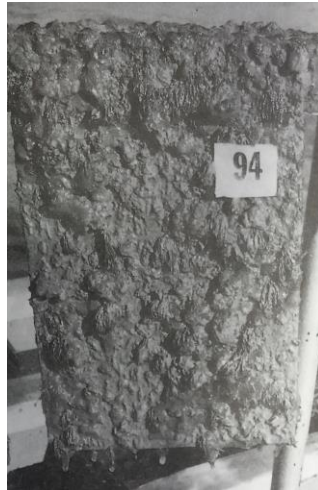
Figura IV.18. Panel de referencia sin protección antiincrustante, 33 meses de inmersión
