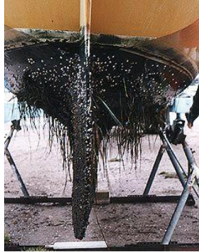
Figura IV.4. Carena colonizada con “biofouling” marino
