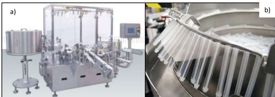
Figura 8.28 – a) Máquina de envasar completa. b) Ampliación del sistema de alimentación de los vástagos
