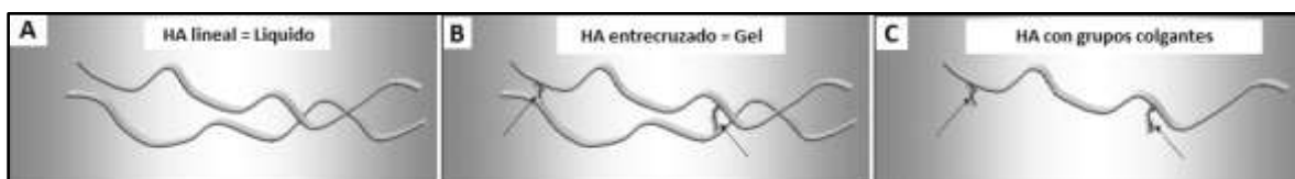
Figura 6.5 - A: representación del HA lineal. B: HA entrecruzado con DVS el cual se encuentra unido con sus dos grupos funcionales. C: DVS unido a la molécula de HA a través de un solo enlace originando los grupos pendientes
