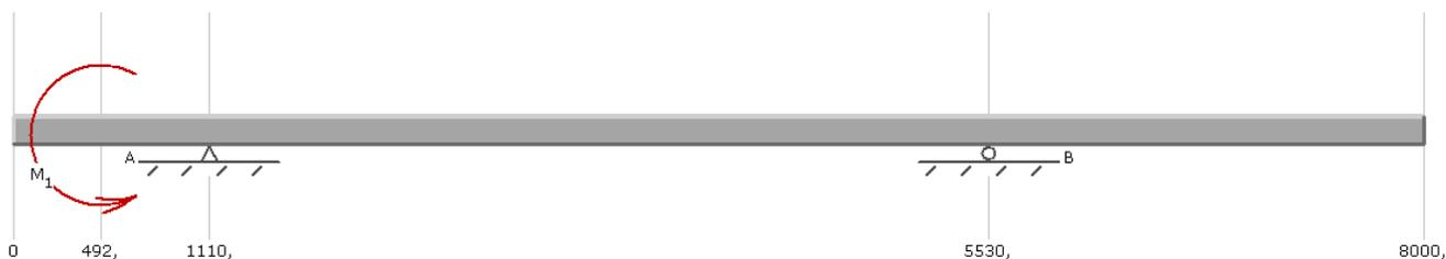
**Figura 2.14.** Diagrama de cargas plataforma en posición vertical
