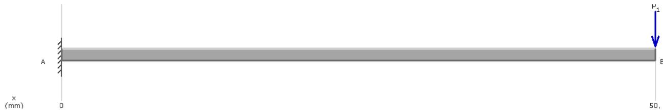
**Figura 7.4.** Diagrama de cargas  $F_c$  actuando sobre el eje motor
