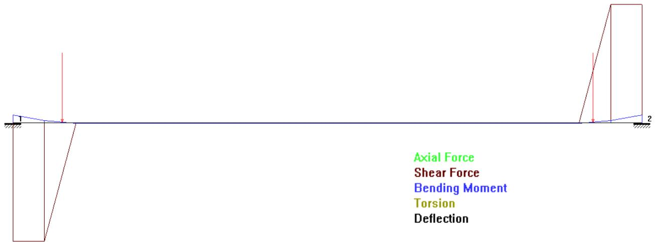
Figura 5.26. Momento flector viga trasera plano XY
