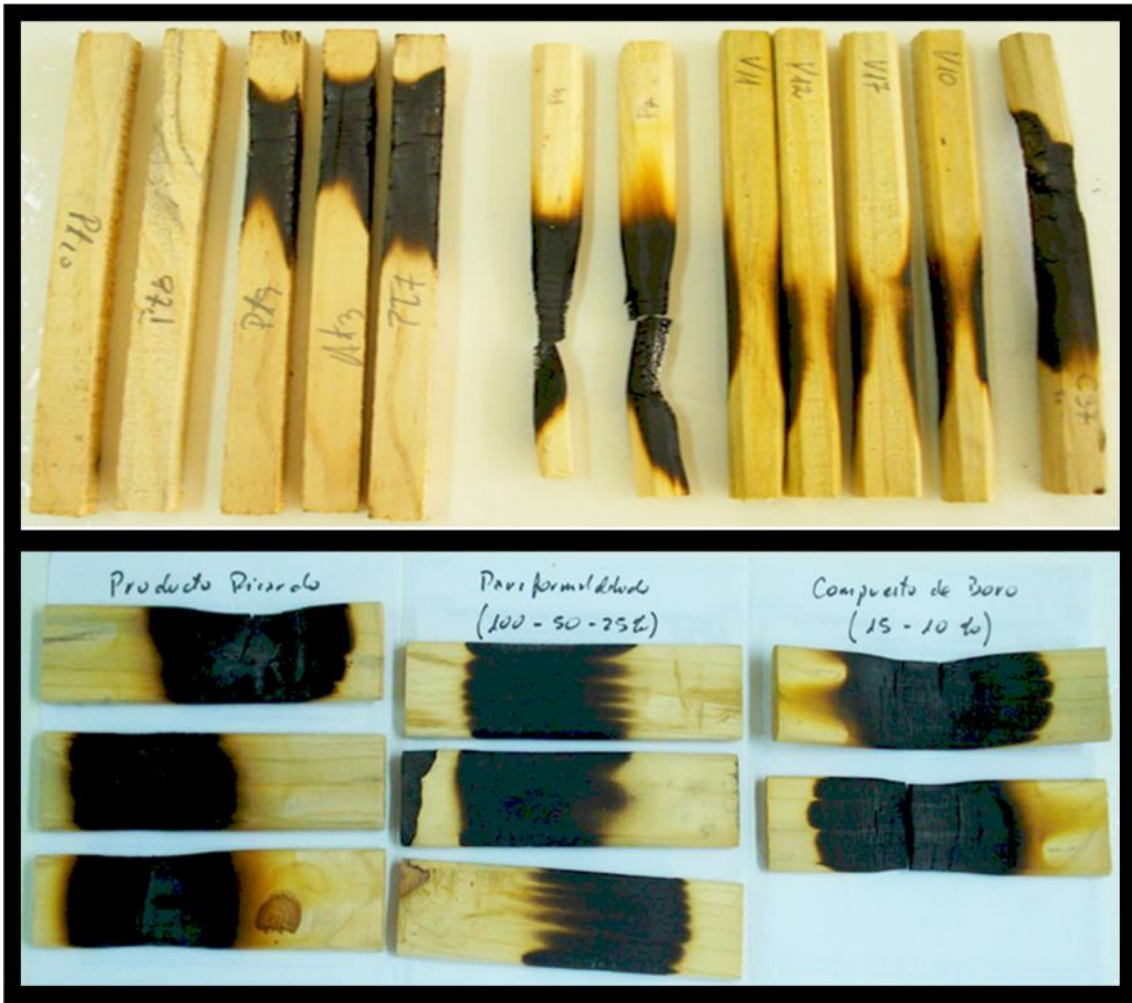
Figura 9 Ensayos de Comportamiento al Fuego (OI) (figura superior) e Intermitente (figura inferior).
