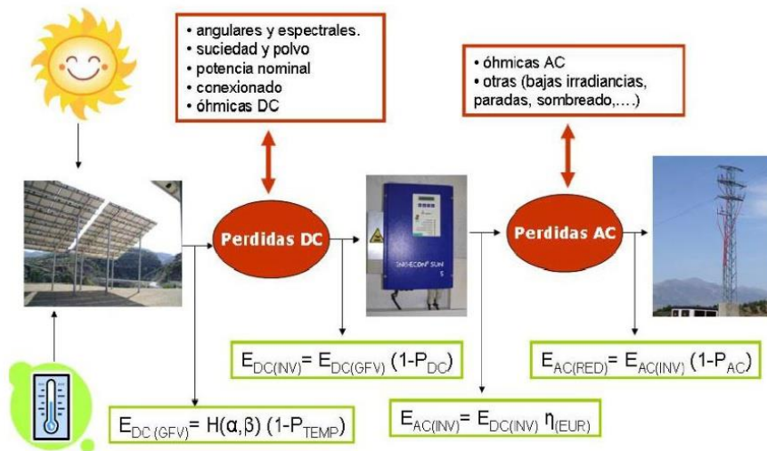
Fig. 43: Esquema del cálculo de la Energía Generada
