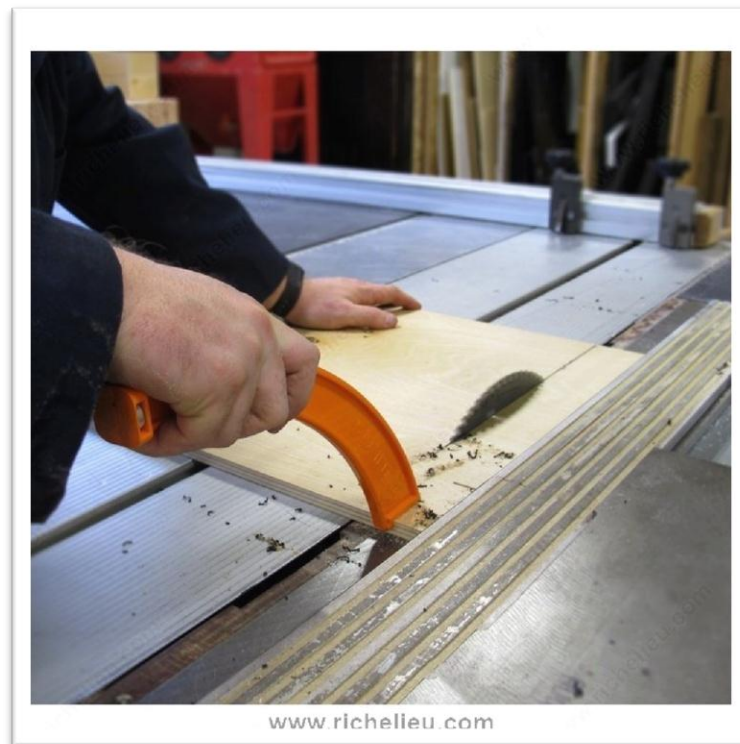
Imagen N°42: Barra de empuje para sierra circular.
