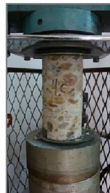
Fig.9. Probetas extraídas para ensayo de compresión simple y RAS
