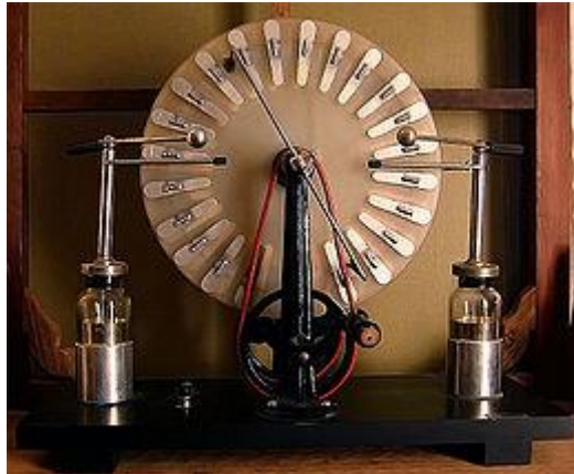
Figura 8: Máquina de Wimshurst.
