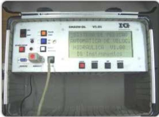
Figura 3. Gabinete de electrónica, correntímetro de IG INSTRUMENTOS
