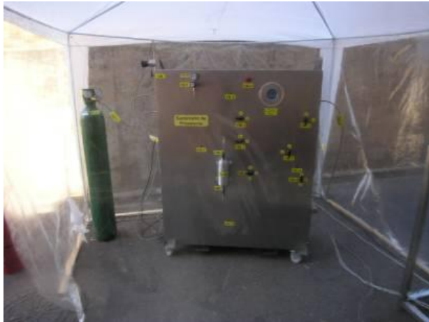
Figura 5. Banco de alimentación y presurizante (N2)
