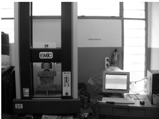
Figura 8. Máquina de tracción utilizada para los ensayos.
