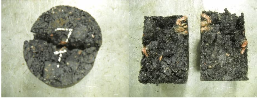
CA-30 con cal sometida a tracción indirecta
