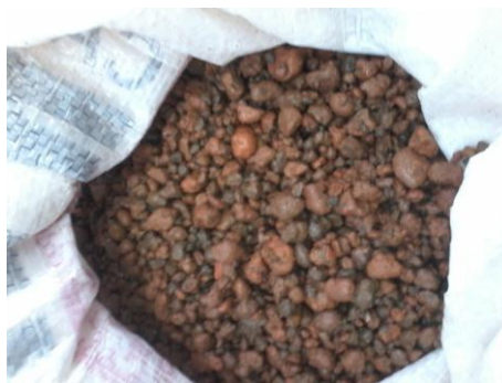
Foto 2: Arcilla expandida por cocción.
