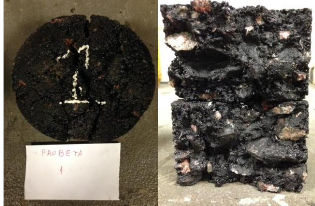
CA-30 con cal sometida a tracción indirecta
