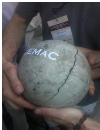
Foto 6: Esfera recién ensayada a compresión.
