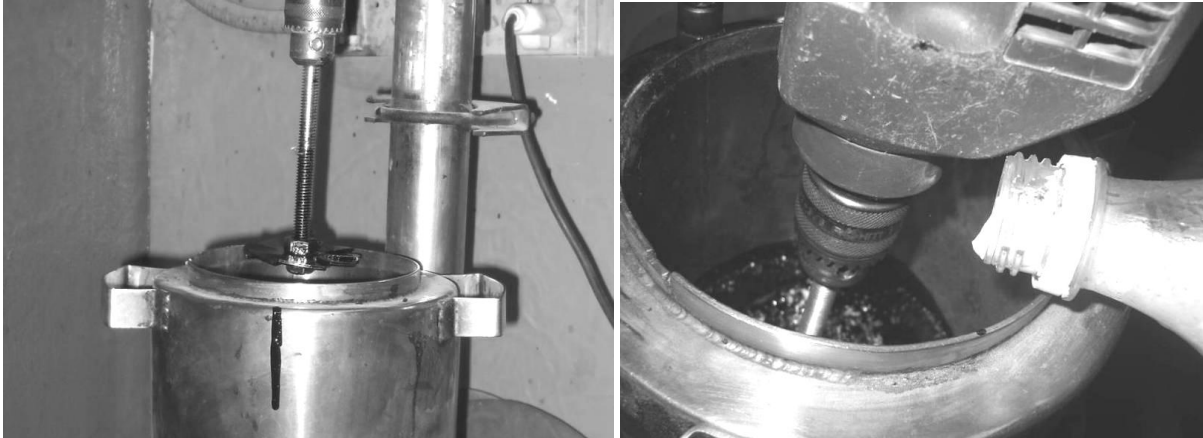
Figura 1: Aditivación con emulsión de SBR en laboratorio
