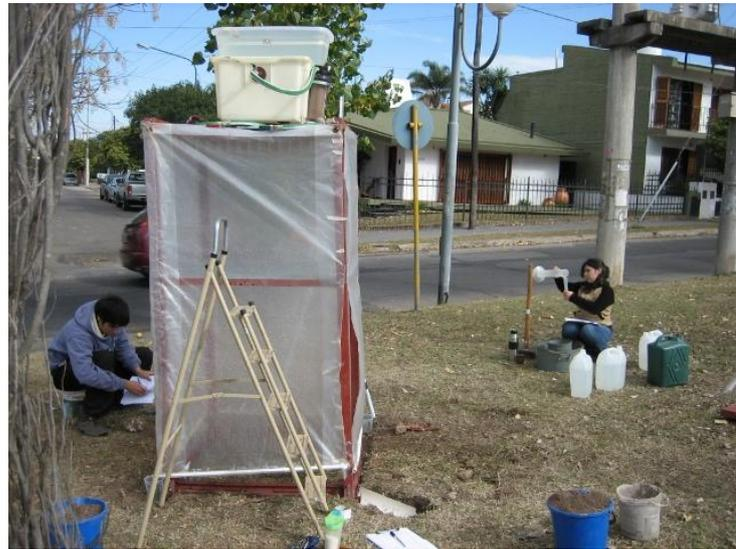
Figura 4. Infiltrómetro y simulador en campaña
