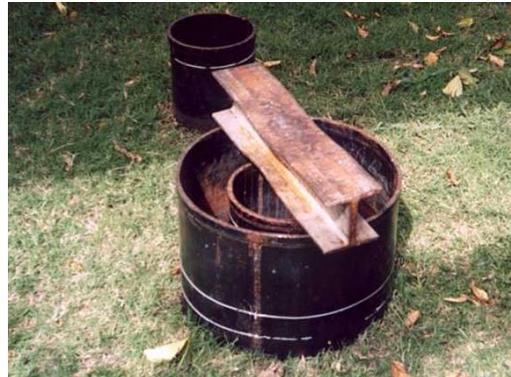
**Figura 1. Infiltrómetro de doble anillo.**
