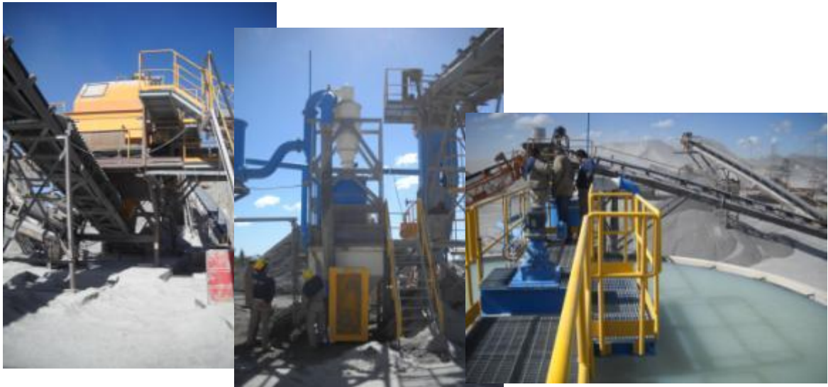
Fotografía 1: Entrada de arena al tamizado y floculación de las fracciones que pasan el Tamiz N° 200.
