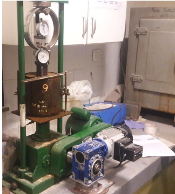
Figura 2. Ensayo de VSR
