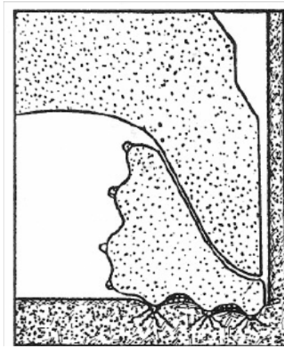
FIGURA 5 - Rotura de la roca. Empuje excesivo.
