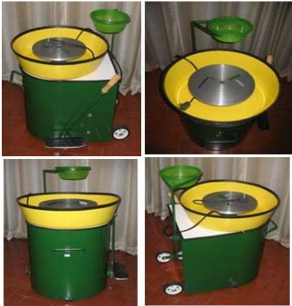
**Figura 12:** Torno Alfarero, Platina de 29 cm. de diámetro, con cono de fijación, amplio Fuentón para recolección de material sobrante y limpieza, Alto: 65 cm. Ancho: 45 cm. Profundidad: 70 cm. Peso aproximado: 35 Kg.
