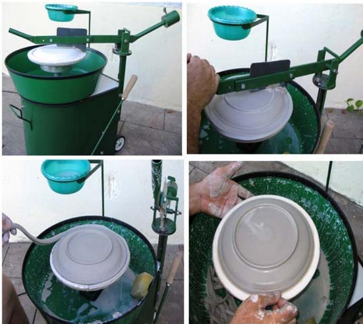
**Figura 11:** Torno Shablom, Platina de 29 cm. de diámetro, con cono de fijación, amplio Fuentón para recolección de material sobrante y limpieza, Alto: 65 cm. Ancho: 45 cm. Profundidad: 70 cm. Peso aproximado: 35 Kg.
