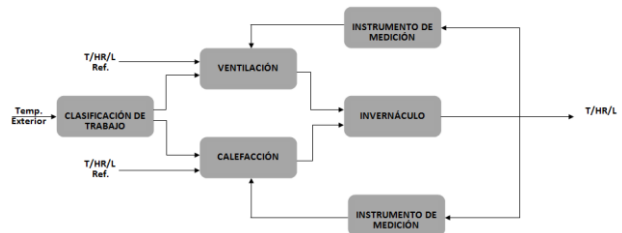
Fig.4- Sistema de control general para el cultivo del clavel
