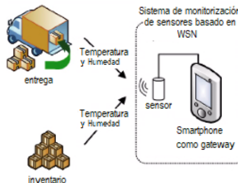
Figura 2 – Lecturas de un sensor de temperatura y humedad empleando WSN [3].
