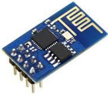
Figura 3. Módulo wifi ESP6288
