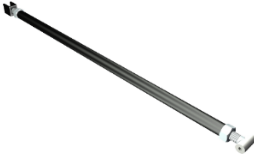
Figura 5.9: Tubo de acoplamiento cilindro – balde.
