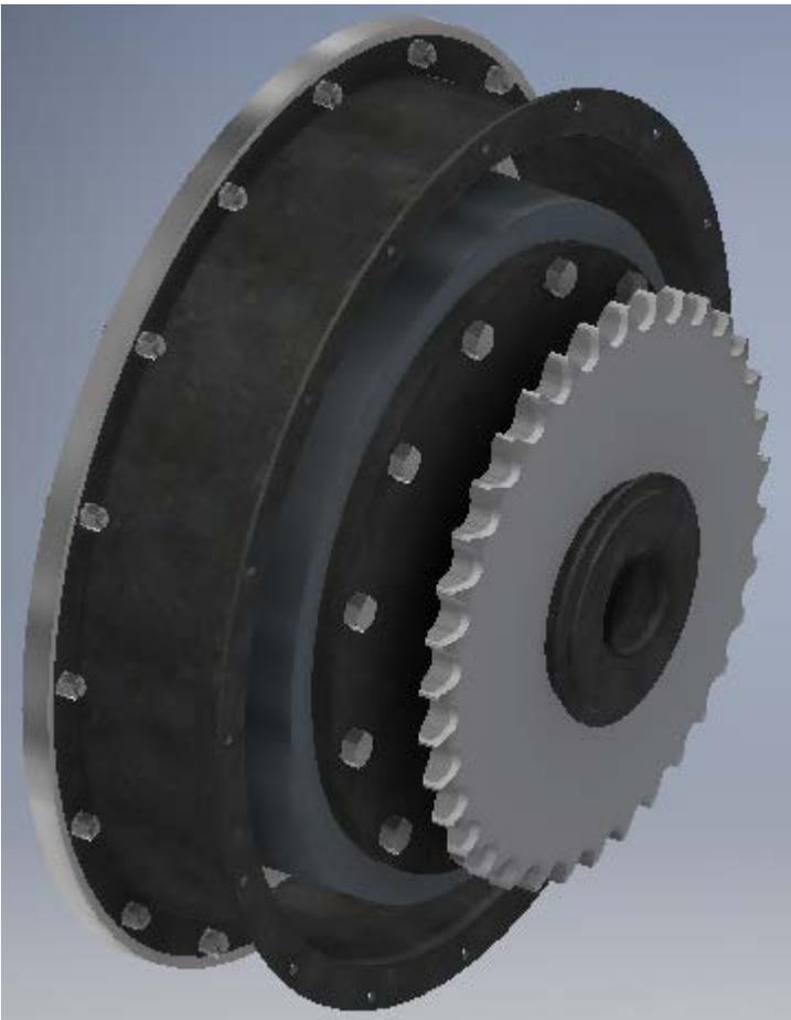
En este caso se utilizará un embrague neumático marca GUMMI, el cual es el encargado de transmitir movimiento al tambor desde el eje principal mediante la aplicación de aire comprimido.
