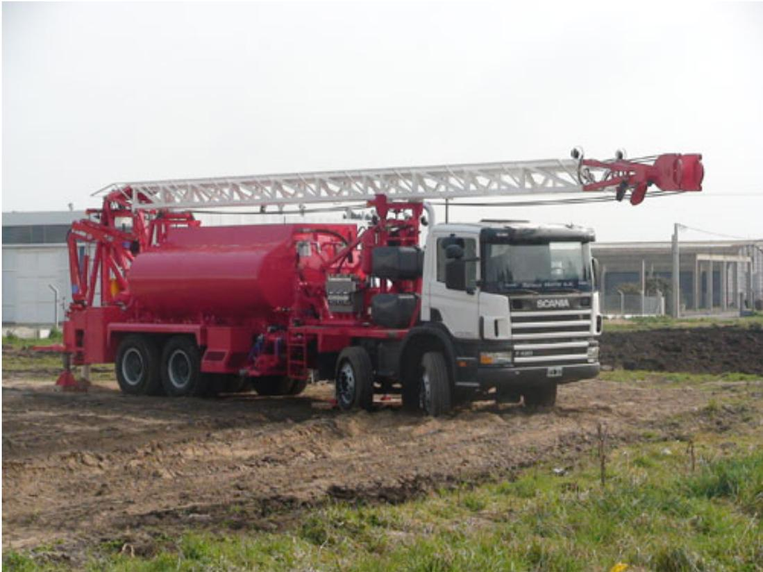
El equipo de flush-by consiste de un camión compuesto por un tanque para almacenar fluidos y su bomba triplex respectiva, con una torre de perforación montada.
