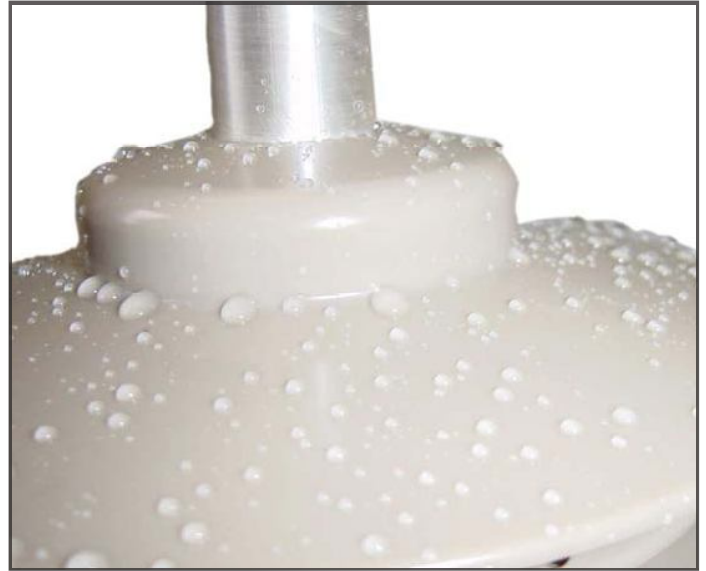
Con hidrofobicidad (HCEP) - HCEP no se torna conductivamente resistente cuando lo se expone a la humedad
