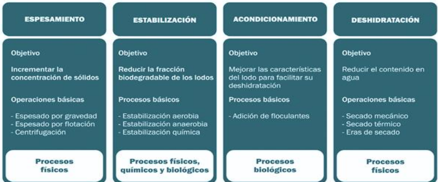
Figura 17 – Tratamiento de la línea de lodos (CENTA, 2008)
