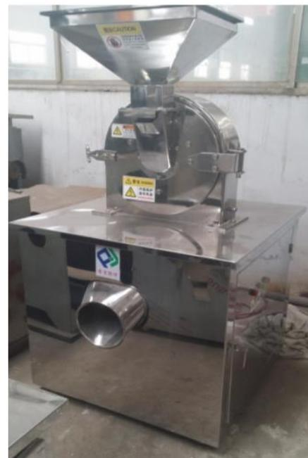
Los tamices controlan el tamaño final de las partículas a la salida de la máquina.
