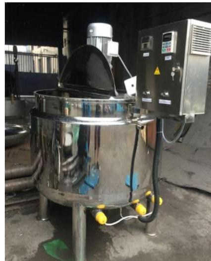
**Bomba, tubo y tanque de 100L:** El coste total de la bomba, el tubo y el tanque pequeño (100L tank) es USD 1650. Ambos elementos se utilizan para transportar el licor de cacao obtenido del molino al tanque térmico (200L), observar la siguiente figura:
