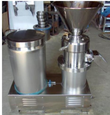
**Tanque térmico:** Se utiliza para almacenar el líquido del licor del cacao, una vez salido del molino.
