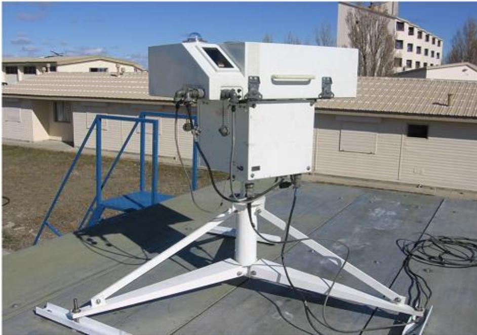
Figura 2.5: Espectrofotómetro Brewer MK IV, instalado en la estación CEILAP-RG.
