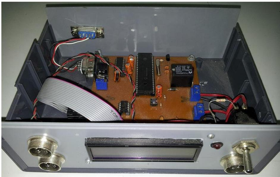
Figura 4.12: Circuito de control de temperatura diseñado para el sistema ERO-DOAS.
