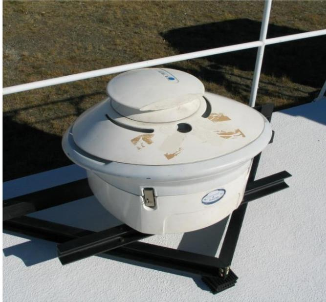
Figura 2.3: Instrumento SAOZ localizado en la estación de sensado remoto CEILAP-RG.
