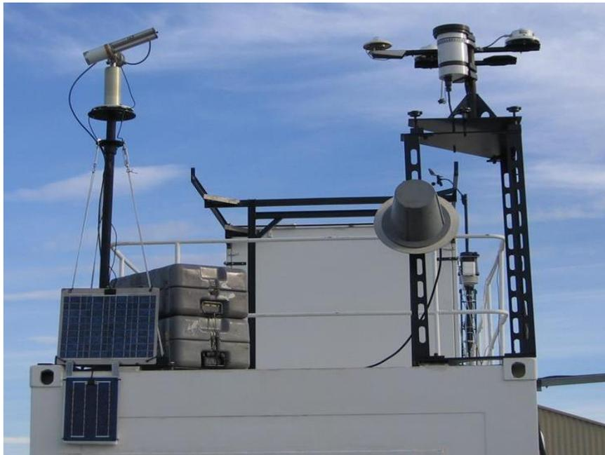
Figura 2.2: Sensores pasivos instalados en la estación de monitoreo de Río Gallegos, Santa Cruz: radiómetro UV-A y UV-B, piranómetro, GUV 541 y un fotómetro solar CIMEL.
