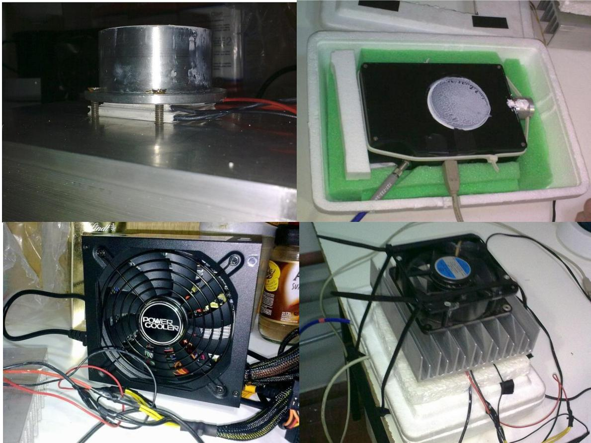
Figura 4.11: Componentes del sistema de refrigeración del espectrómetro HR4000: fuente switching, cooler, disipador, espectrómetro, celdas Peltier, recipiente de poliestireno expandido y pieza de aluminio para acople térmico.
