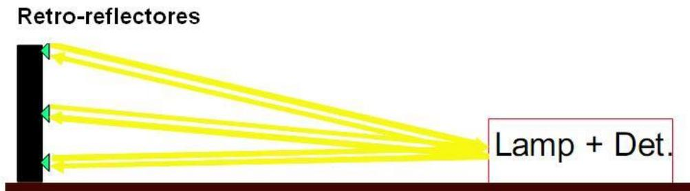
Figura 2.10: Configuración vertical profiling LP-DOAS, para obtener perfiles verticales usando retro-reflectores ubicados en sentido vertical. (Adaptado de Platt and Stutz, 2008)
