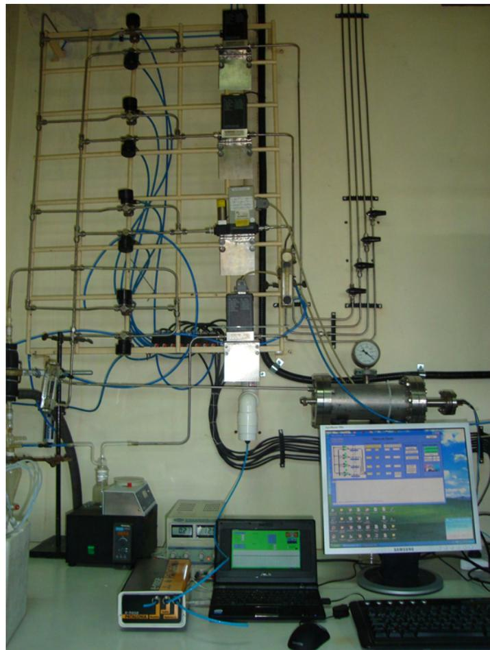
Figura 91. Vista del banco de gases construido en instalaciones de CNEA
