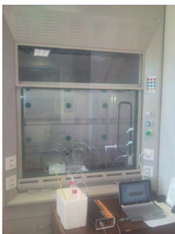
Figura 29. Vista de campana de gases y del dispositivo de medición de TMA y merluza.
