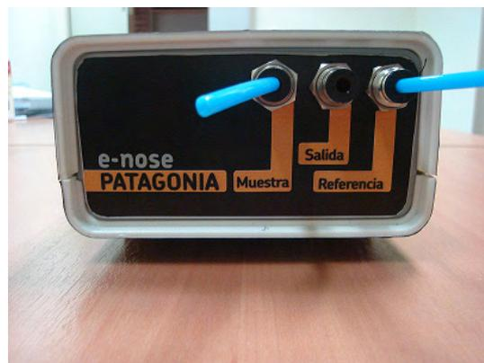
Figura 79. Sistema de Muestreo de la Nariz Electrónica Genérica Portátil (Modelo PATAGONIA)
